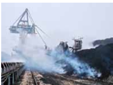
Sl. 5: Samozapaljenje uglja na deponiji
